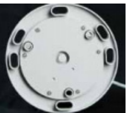
Installation La plaque de fond du SC 110 peut être fixée sur une structure grâce à des boulons 3 ou 4 x M12 sur un diamètre de 200 mm ou 3 x M8 sur un 150 mm
